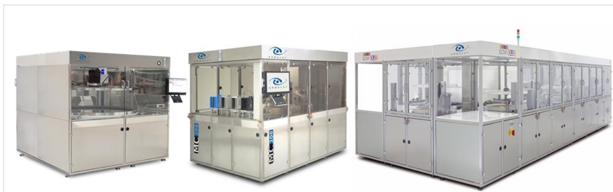
Obducats produkter för resist processing är uppbyggda kring ett antal standardiserade moduler som täcker en rad olika processbehov inom FoU såväl som högvolymtillverkning.
